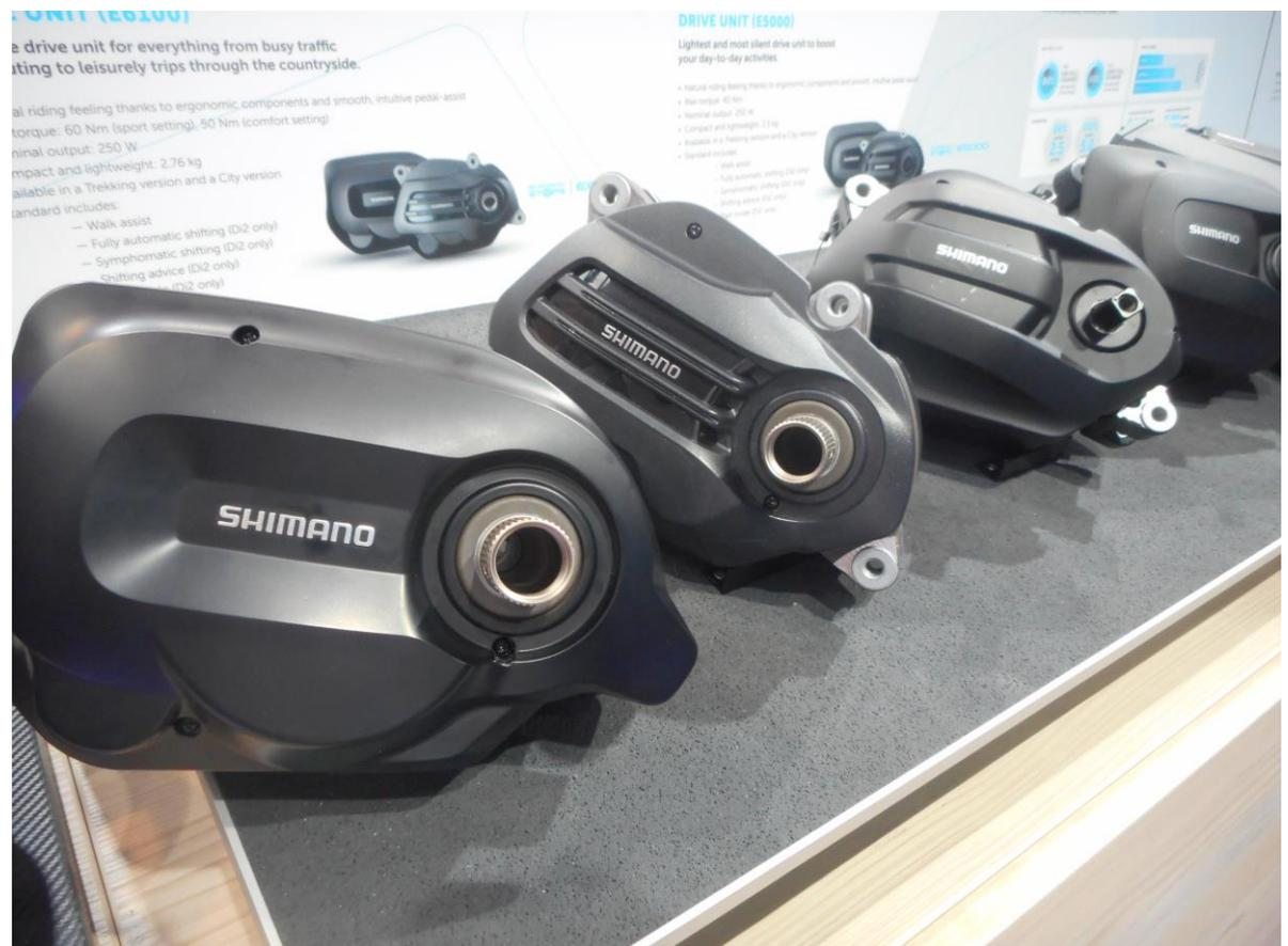
Les moteurs modernes possèdent trois capteurs qui mesurent plus de 1000 fois par seconde la puissance, la fréquence de pédalage ainsi que la vitesse afin d'assurer une parfaite harmonie entre la puissance développée par le cycliste et l'assistance fournie.
